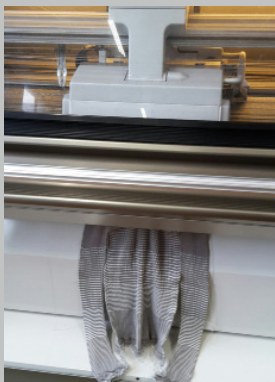
In einem Stück nahtlos gestrickt.
