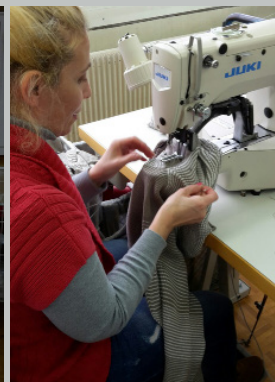
„Verriegeln“ der Restfäden.
