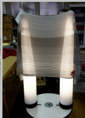
Qualitätskontrolle am Lichtbalken.
